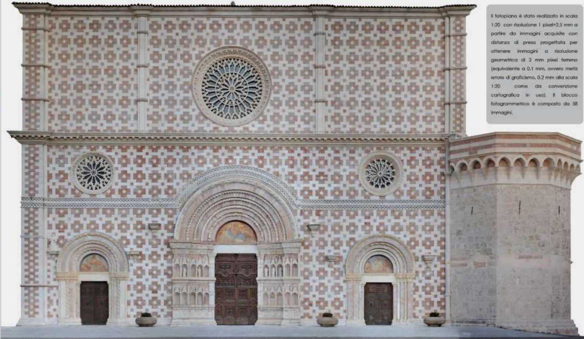
Il fotopiano è stato realizzato in scala 1:20 con risoluzione 1 pixel=2.5 mm a partire da immagini acquisite con distanza di presa progettata per ottenere immagini a risoluzione geometrica di 2 mm pixel terreno (equivalente a 0.1 mm, ovvero metà errore di graficismo, 0.2 mm alla scala 1:20 come da convenzioni cartografica in uso). Il blocco fotogrammetrico è composto da 58 immagini.
